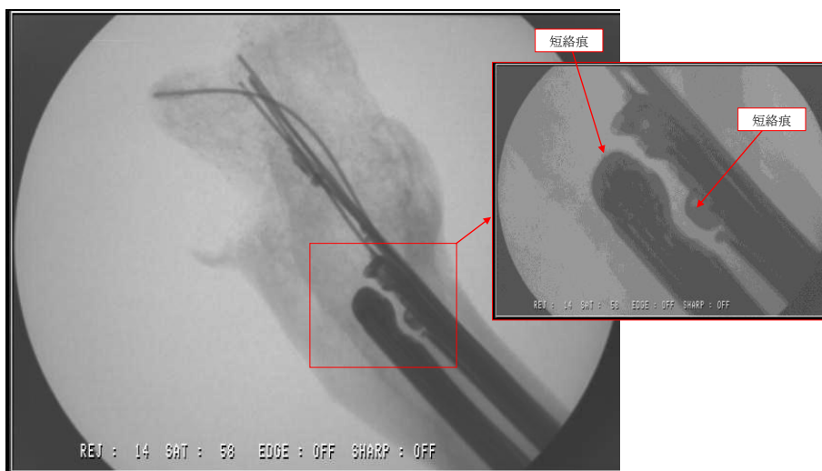
写真 17 3 ロタップコードの断線部の X 線写真
