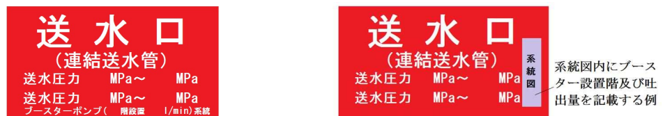
第21-6図 加圧送水装置が設置されている連結送水管の標示例
