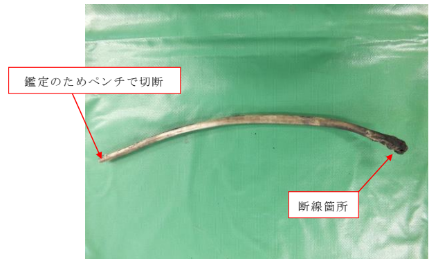
写真 16 3 ロタップのコードの状況
