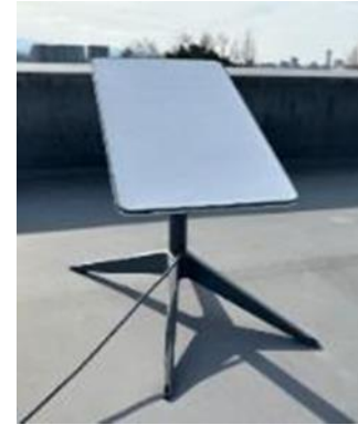
スターリンク 可搬式通信 アンテナ
