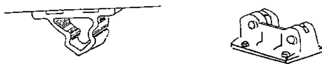
図 3-1-1 計算による強度確認を行う必要のない緊締金具及びすみ金具
