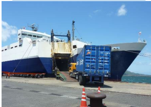
RORO船の荷役状況
