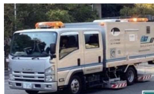
空洞探査車による空洞調査
