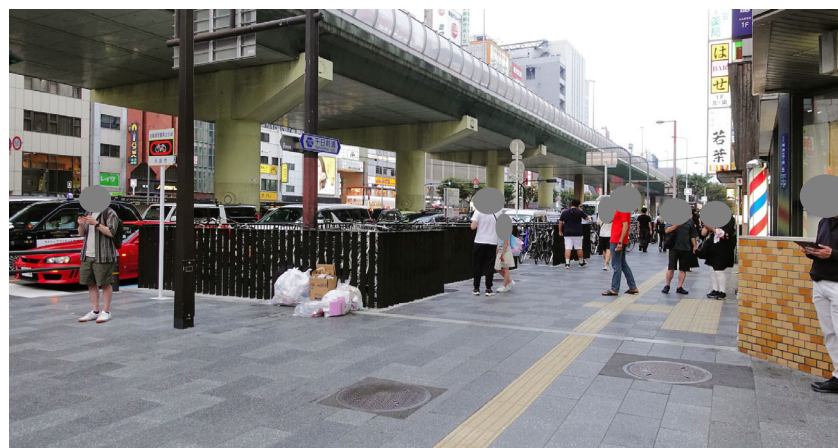
▼御堂筋と交差する千日前通の歩道上駐輪場の整備 (車線数削減し歩道拡幅) ⇒機械式駐輪器具の設置、目隠しフェンスの設置
