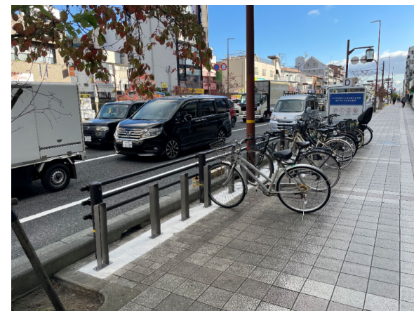
▼御堂筋と交差する千日前通の歩道上駐輪場の整備 (車線数削減し歩道拡幅) ⇒機械式駐輪器具の設置、目隠しフェンスの設置
