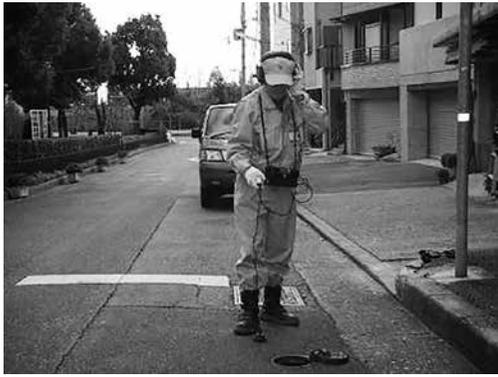
写真1：漏水探知機による路面音聴調査
