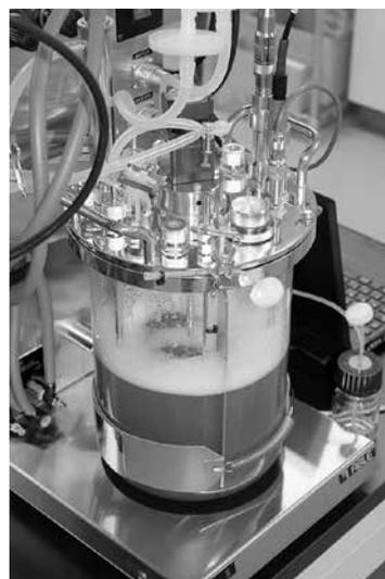
図2 バイオリアクターを用いたCHO細胞培養
