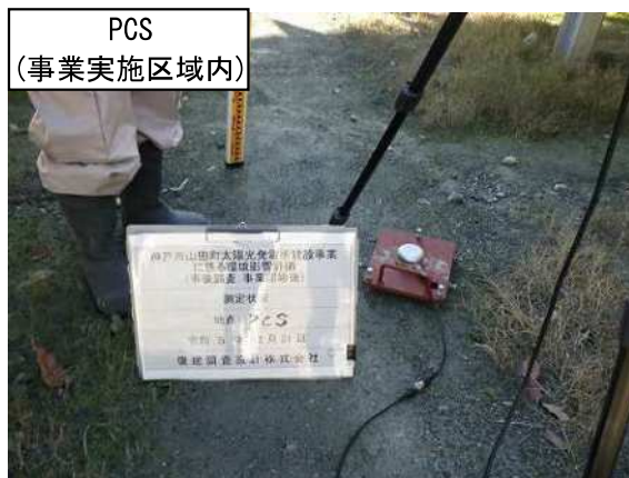
写真 3.2-1 調査の実施状況（施設稼働に伴う振動）（令和 5 年 12 月 21 日撮影）
