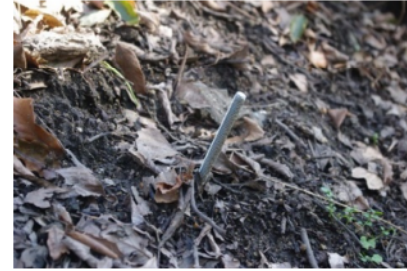
侵食状況を測定するための杭
