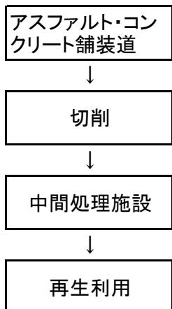
がれき類(アスファルト・コンクリート殻)→收集運搬→破碎→再生利用
