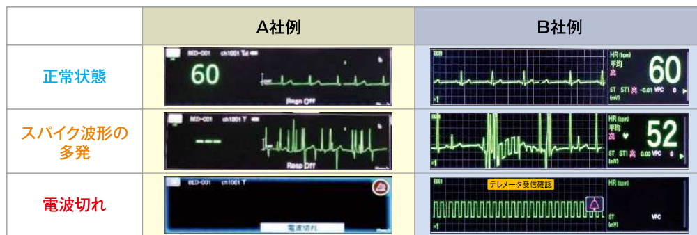
《付図3-2》 セントラルモニタ波形例 ※機種や電波の状態により表示が異なる
