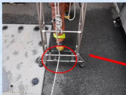
三連はしご下部 救出ロープの状況 (踏み棧に下からロープを通す)
