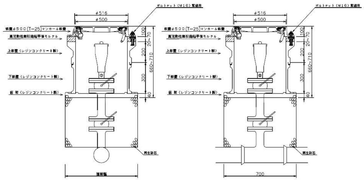
4-3-2, 仕切弁鉄蓋の据付標準図
