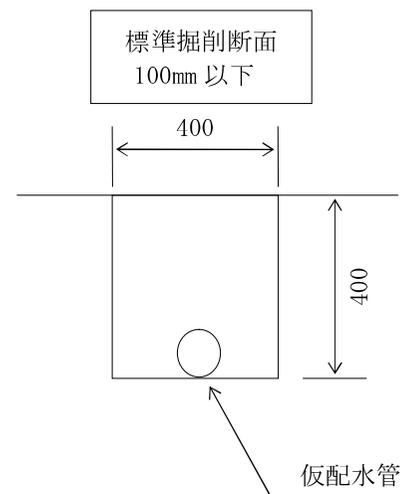
4-2-2, 給水管付替の標準掘削断面
