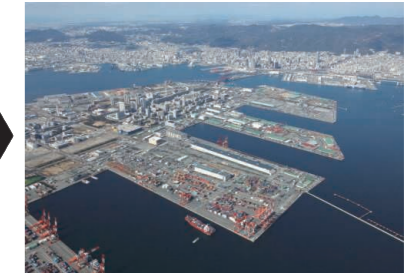
町と港を広げるため、海を土でうめて新しい島をつくりました。
