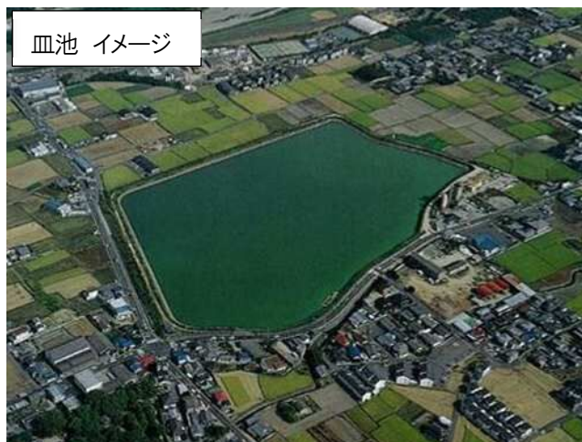
平地で窪地の周囲に堤防を築いて造られたため池
