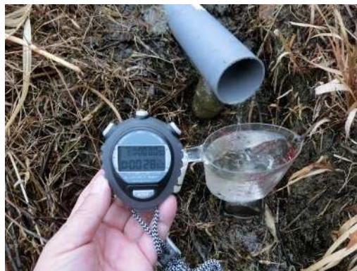
後法 漏水量測定(近景)
