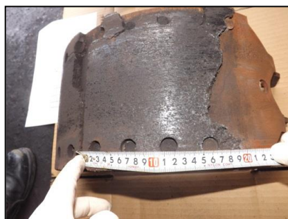
引きずりを起したライニング
