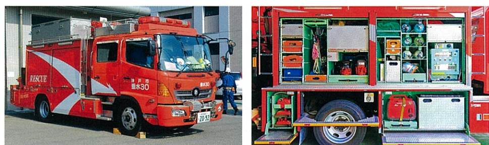
特別高度救助隊 救助工作車(クレーン・ウインチ等装備) 積載庫は専任救助隊の車両と統一
