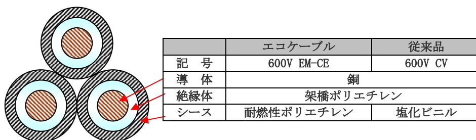
低圧ケーブルの断面例
