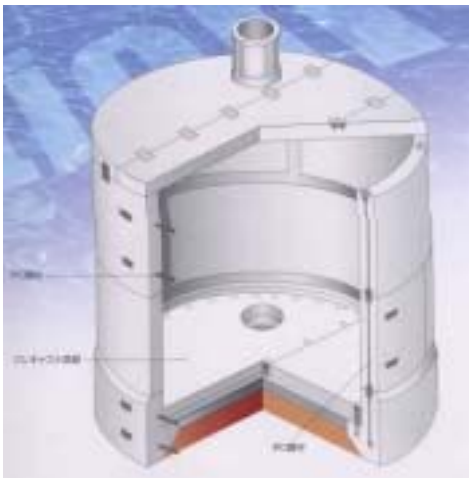
コンクリート製の例
