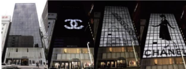
◆ファサードライティング：建築物の表面に LED 等の光源を設置し、色や明るさに変化を持たせる照明演出
