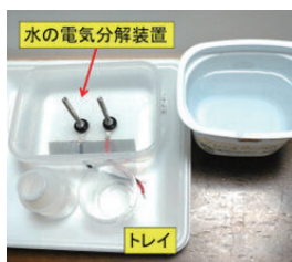
身近な材料を使って水の電気分解を行う実験
