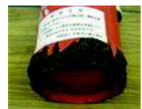
底部が錆びた消火器
