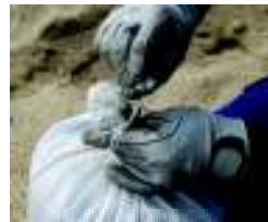
指に紐を通して2,3回まわし、指の穴を通して縛る
