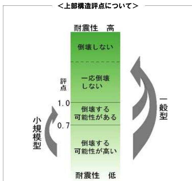
上部構造評点とは、建築物の構造強度を示す指標の一つです。
