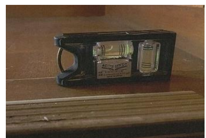
建物の傾き状況を水平器で測定
