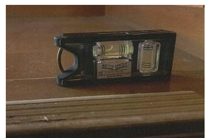
建物の傾き状況を水平器で測定
