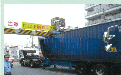
■ 特殊車両が「高さ制限バー」を損壊した事故事例
