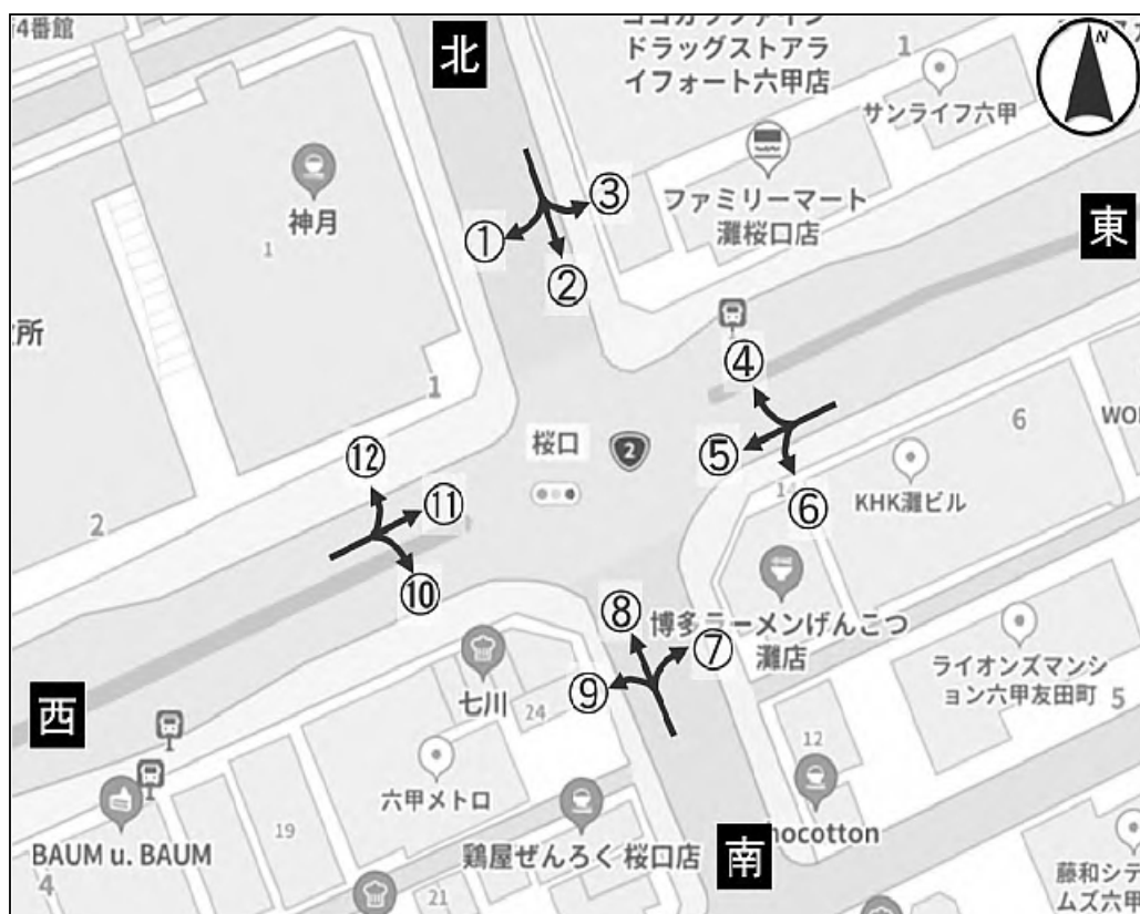
図 1-3 (3) 車両交通量 計測方向案内図 (地点 2)
