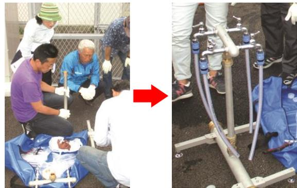
②応急給水資材保管庫から手動ポンプ、サクシオンホース、分岐栓、消防用接続ホース、仮設給水栓収納袋を取り出す。
