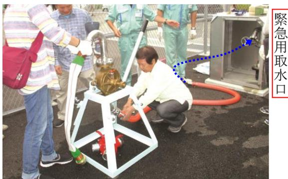
⑥手動ポンプのハンドルを垂直に対して約40度の角度で左右に揺動する。空気を吸い込んでいる間はできるだけ早く操作してポンプ内部に水を吸い上げる。
