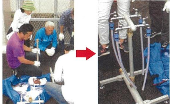
②応急給水資材保管庫から手動ポンプ、サクシオンホース、分岐栓、消防用接続ホース、仮設給水栓収納袋を取り出す。
