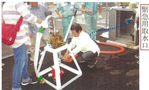
⑥手動ポンプのハンドルを垂直に対して約40度の角度で左右に揺動する。空気を吸い込んでいる間はできるだけ早く操作してポンプ内部に水を吸い上げる。
