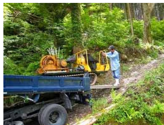
簡易な架線による発生材搬出例
