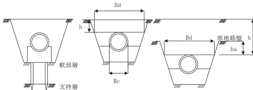
(a) 杭基礎の場合 (b) 溝が広い場合 ( $Bd \geq 2Bc$ ) (c)  $h_a$  が  $Ba/2$  以下の場合
