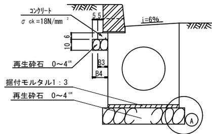
標準施工断面図(セミフラット型)
