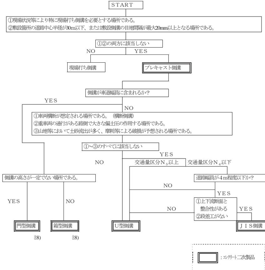
8-10 コンクリート二次製品による街渠工の運用例
