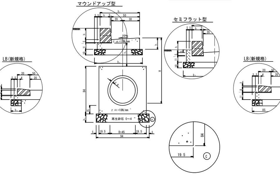
Hの変化によるh<sub>1</sub>, h<sub>5</sub>の変化
