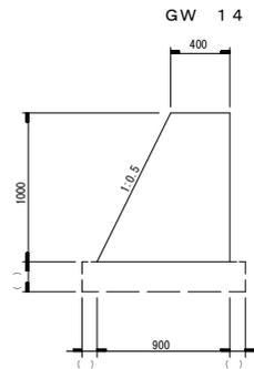
場所打擁壁工（構造物単位）－重力式コンクリート擁壁
