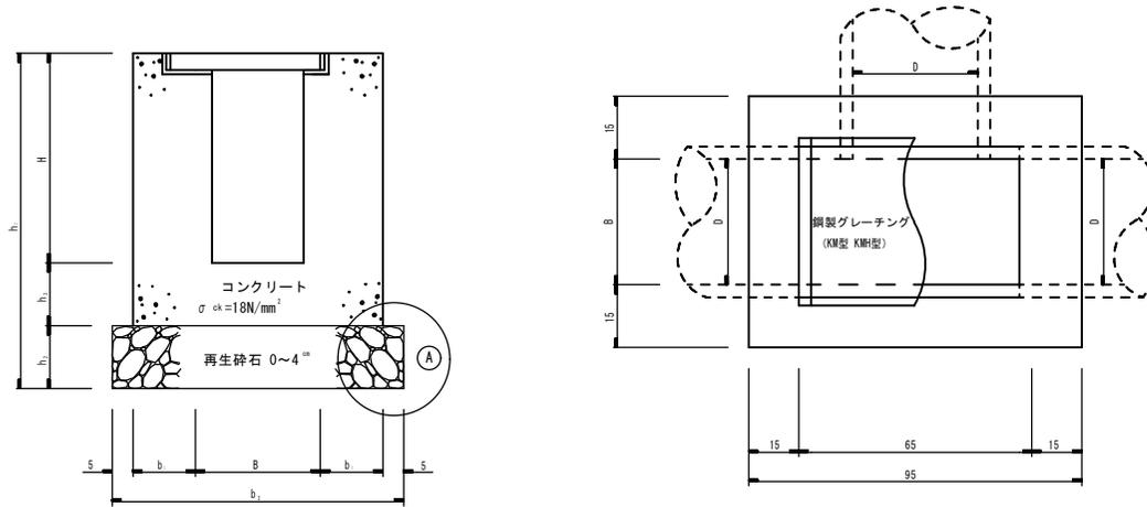
Hの区分によるh<sub>2</sub>, h<sub>3</sub>の変化
