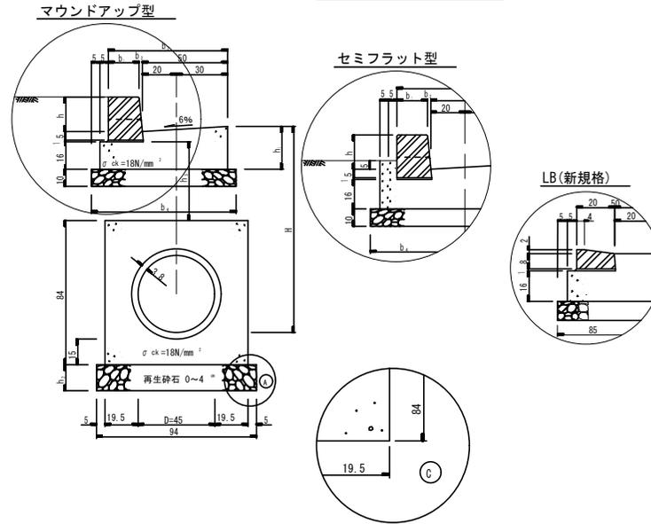
Hの変化によるh<sub>1</sub>, h<sub>3</sub>の変化
