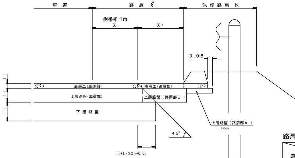
(二層式、防護柵、アスファルト縁石設置)
