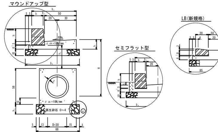
Hの変化によるh<sub>1</sub>, h<sub>s</sub>の変化
