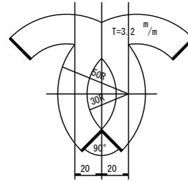
市章文字及び斜模様材は3.2 鉄板で仕上げ溶接止めとする。
