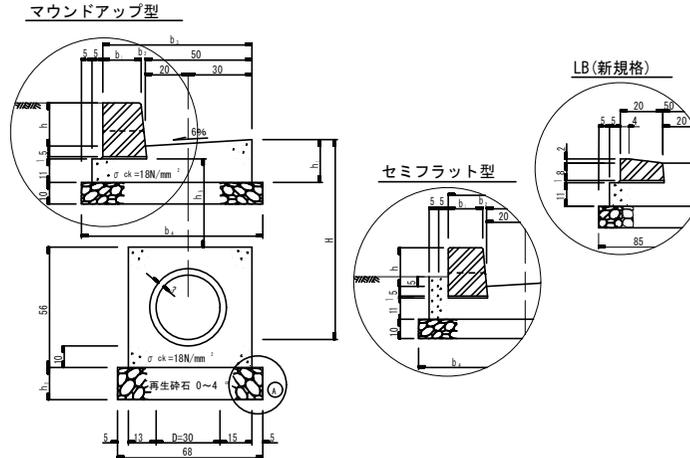
Hの変化によるh<sub>1</sub>, h<sub>5</sub>の変化
