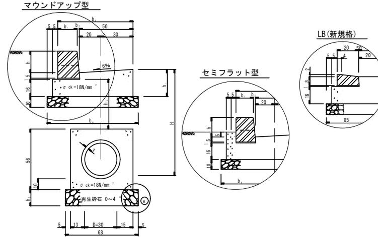
Hの変化によるh<sub>1</sub>, h<sub>5</sub>の変化
