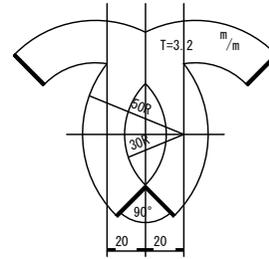
市章文字及び斜模様材は3.2 鉄板で<sup>m</sup>/m仕上げ溶接止めとする。
