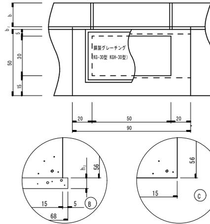
Hの変化によるh<sub>1</sub>, h<sub>5</sub>の変化
