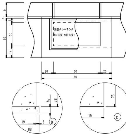
Hの変化によるh<sub>1</sub>, h<sub>5</sub>の変化
