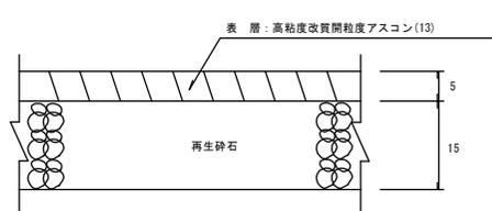
※細粒度5cmを透水性アスファルト混合物に替えて、特にフィルター層は設けない構造とする。
