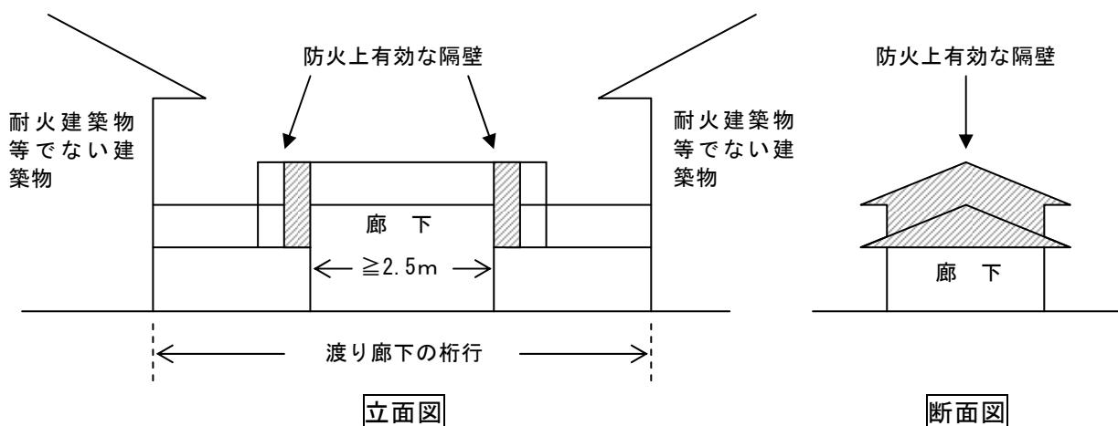
※耐火建築物等：耐火建築物、準耐火建築物又は法第27条第1項の規定に適合する特殊建築物（令第109条の2の2に規定する特定避難時間倒壊等防止建築物であって令第110条第1号に規定する特定避難時間が45分間未満の建築物を除く。）
